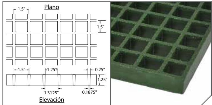
Propiedades de las Secciones por Pie de Ancho: A = 2.16 IN<sup>2</sup> I = 0.32 IN<sup>4</sup> S = 0.48 IN<sup>3</sup>
