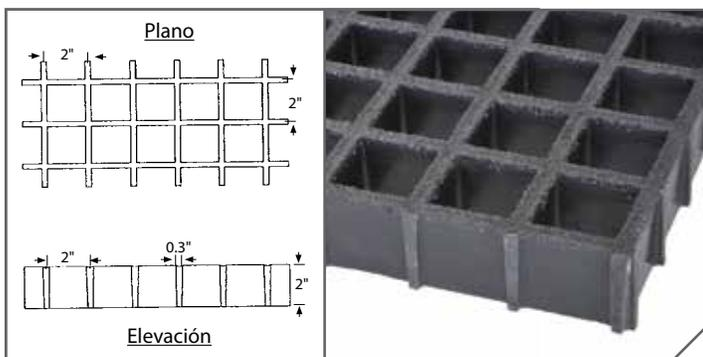
Propiedades de las Secciones por Pie de Ancho: A = 2.88 IN<sup>2</sup> I = 0.96 IN<sup>4</sup> S = 0.94 IN<sup>3</sup>
