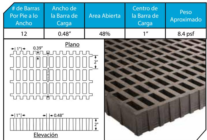
Propiedades de la Sección por Pie de Ancho: A = 10.26 Pulgadas<sup>2</sup> I = 3.4 Pulgadas<sup>4</sup> S = 3.27 Pulgadas<sup>3</sup>
