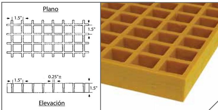
Propiedades de las Secciones por Pie de Ancho: A = 2.85 IN<sup>2</sup> I = 0.51 IN<sup>4</sup> S = 0.65 IN<sup>3</sup>
