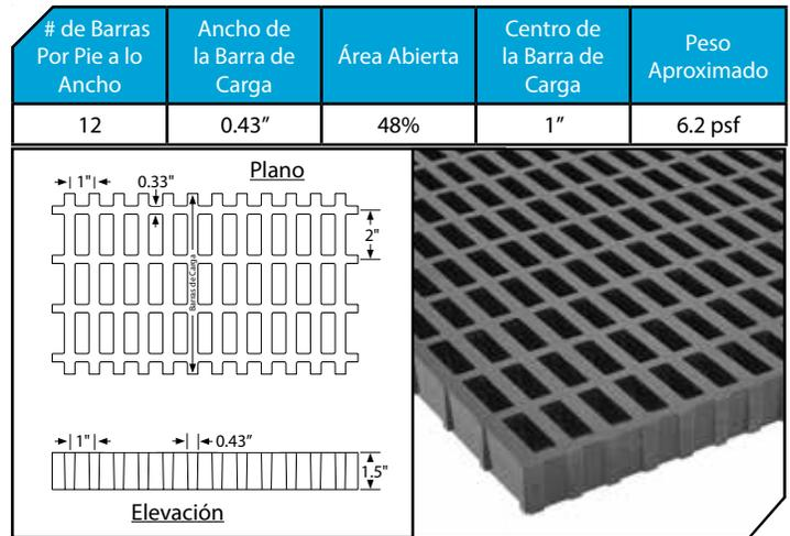
Propiedades de la Sección x Pie de Ancho: A = 7.45 Pulgadas<sup>2</sup> I = 1.39 Pulgadas<sup>4</sup> S = 1.80 Pulgadas<sup>3</sup>
