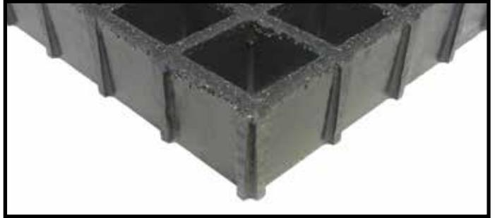
**Superficie Con Arenilla Aplicada Integralmente:** Las rejillas de Fibergrate con adherencia opcional, tienen arenilla de cuarzo integralmente aplicada, curada y sellada sobre la superficie, ofreciendo una excelente característica antiderrapante.
