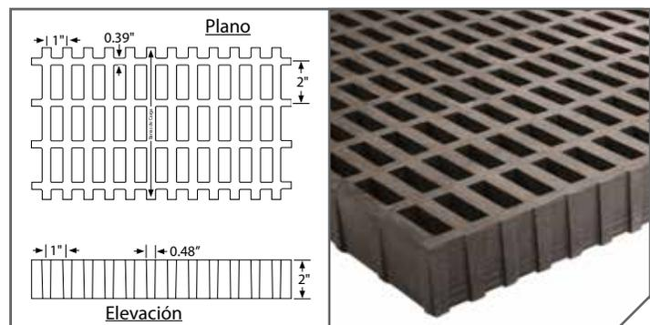
Propiedades de las Secciones por Pie de Ancho: A = 10.26 IN<sup>2</sup> I = 3.4 IN<sup>4</sup> S = 3.27 IN<sup>3</sup>
