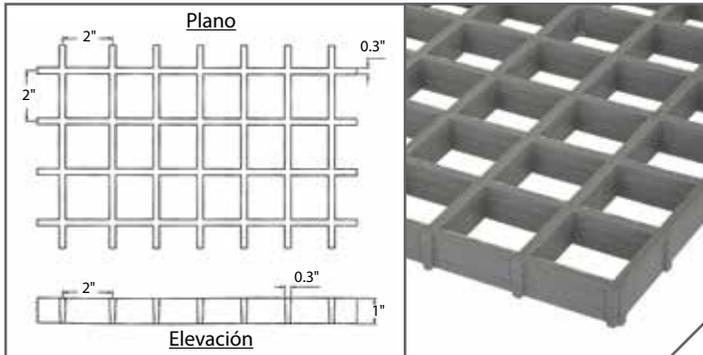
Propiedades de las Secciones por Pie de Ancho: A = 1.27 IN<sup>2</sup> I = 0.11 IN<sup>4</sup> S = 0.21 IN<sup>3</sup>
