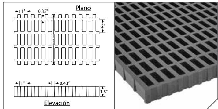
Propiedades de las Secciones por Pie de Ancho: A = 7.45 IN<sup>2</sup> I = 1.39 IN<sup>4</sup> S = 1.80 IN<sup>3</sup>
